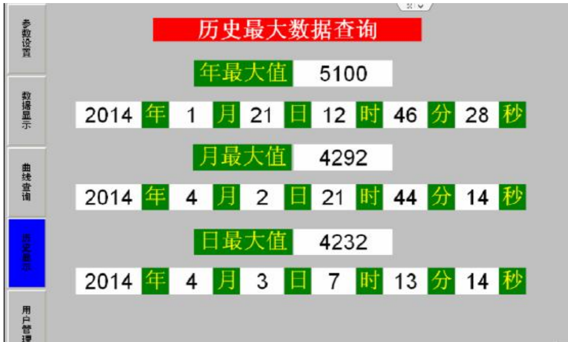
图 3：用户二未实施控制的 1 月份最大需量 5100 千瓦（4 月份起设定值 4300 千瓦）
